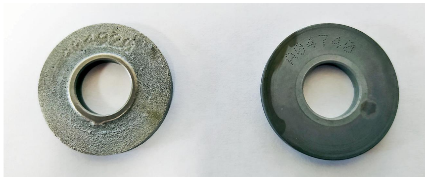
Рис. 4. Внешний вид образцов-свидетелей коррозии из стали марки 09Г2С после испытаний: а) без ингибитора (скорость коррозии – 1,19 мм/год); б) с ингибитором (скорость коррозии – 0,02 мм/год)
